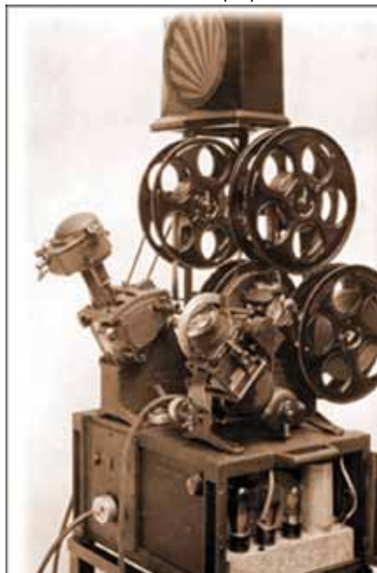
La Moviola américaine, première table de montage sonore (1928), équipée d'un lecteur image et d'un lecteur son optique.
